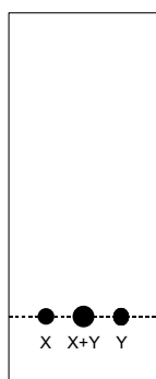
Joonis 1.1 Laigud TLC plaadil enne voolutamist: X – 1,4-DHP, Y – reaktsioonisegu.
